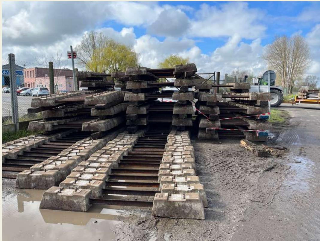
Traverses bi-blocs en béton armé
